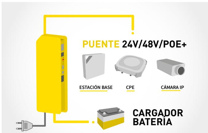
Gracias a la fuente PoE Gigabit puede alimentar cualquier carga estándar como PoE+, dispositivos 802.3af y 802.2at, cámaras IP, teléfonos IP, centralitas, puntos de acceso, switches, CPE, routers, dando tensión en caso de apagón. La tensión de salida se puede seleccionar desde 24 a 52V.
